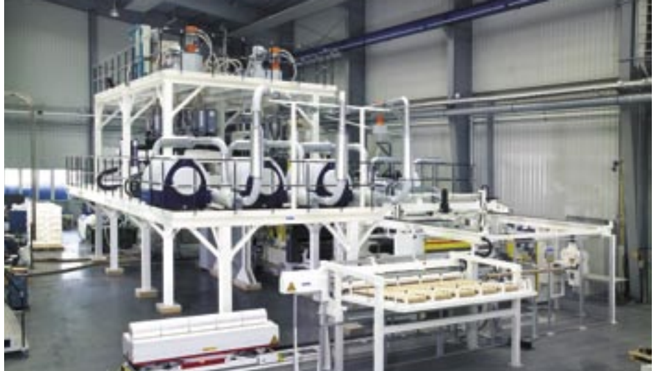
Neu entwickelte Hochgeschwindigkeitsanlage zur Herstellung von industrieller Palettenstretchfolie Newly developed high-speed line for producing industrial pallet stretch wrap film
